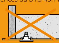
Pas de contact entre les points chauds et l'isolant.
