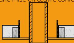
Réalisez un arrêtoir rigide en métal, bois, plâtre ou panneau rigide d'isolant classé au moins A2-s1, d0, à une distance de sécurité définie dans le NF DTU 24.1.
