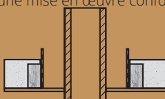
Réalisez un arrêtoir rigide en métal, bois, plâtre ou panneau rigide d'isolant classé au moins A2-s1, d0, à une distance de sécurité définie dans le NF DTU 24.1.
