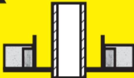
Réalisez un arrêtoir en métal, bois, plâtre ou panneau rigide isolant au moins A2-s1, d0, à une distance de sécurité définie dans le NF DTU 24.1, autour des conduits de fumée.
