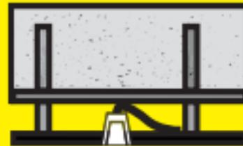
Réalisez un plénum pour maintenir l'isolant à une distance d'au moins 10 cm des spots encastrés.
