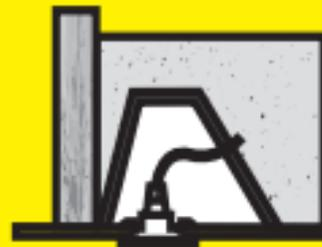
Posez un capot de spot étanche et conforme au NF DTU 45.11 sur chaque spot halogène ou LED.
