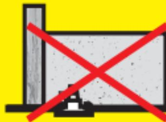
Pas de contact entre les éléments dégageant de la chaleur et l'isolant.
